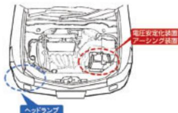
バッテリー付近に取付ける後付電装品（電圧安定化装置、HID ヘッドランプ等）の起因による火災や製品の不適切な取付けが原因と推定される火災が発生しています。このような後付製品を購入する場合には、取付け際の注意事項を確認しておきましょう。
